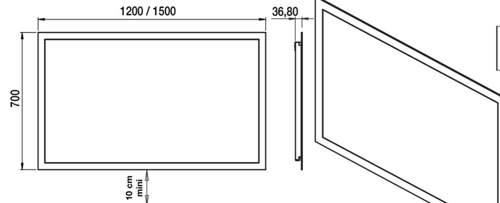
Pour le bon fonctionnement de l'interrupteur sensible aucun objet ne doit se trouver à moins de 10 cm.
